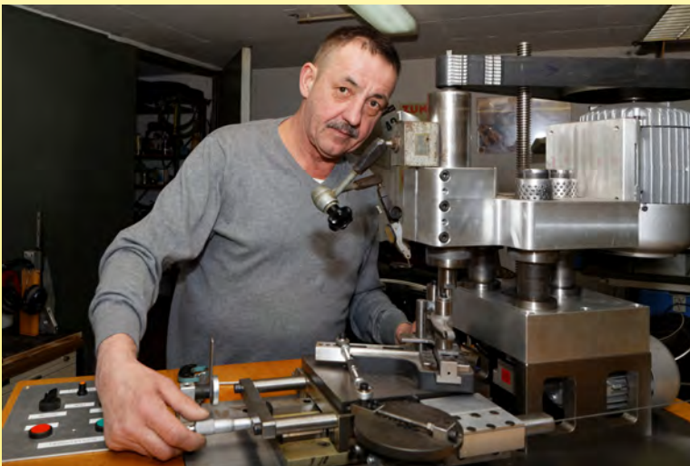
Dietmar Wolf bei der Arbeit an der von ihm konstruierten und aufgebauten Kipphebel-Spezialschleifmaschine
